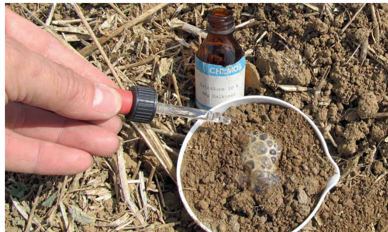
Salzsäuretest auf freien Kalk: Wenn die Säure aufbraust, gibt es freien Kalk, wenn nicht, fehlt er – wichtige Hinweise auf Fähigkeit des Bodens, Säuren zu neutralisieren und für eine stabile Bodenstruktur.
